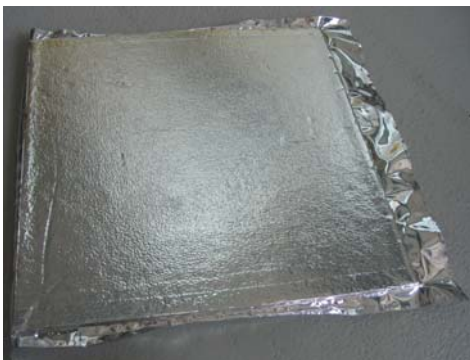
Fig. 1: Oben: Schematischer Schnitt durch das VIP Vaku-Isotherm mit umgelegten Rändern. Links: Foto eines aufgeschnittenen Paneels.
